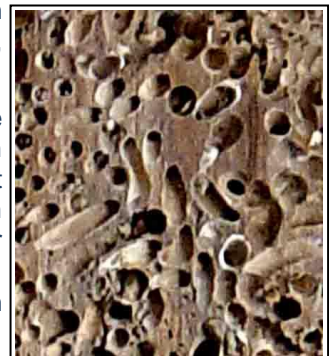
Abb.11 - Ergebnis des Bohrwurmes im Querschnitt
