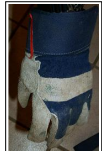
Abb.11 Leder- /Textil- Schutzhandschuh zum Schutz vor mechanischen Gefahren
